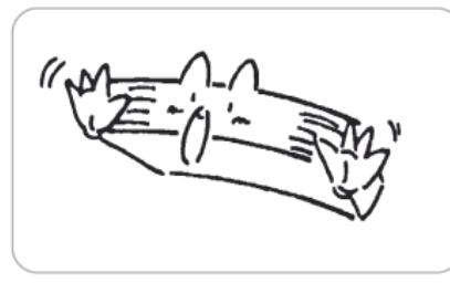
Запрещается препятствовать проходу потока воздуха через внутренний или наружный блоки; в противном случае может возникнуть сбой работы блоков.
