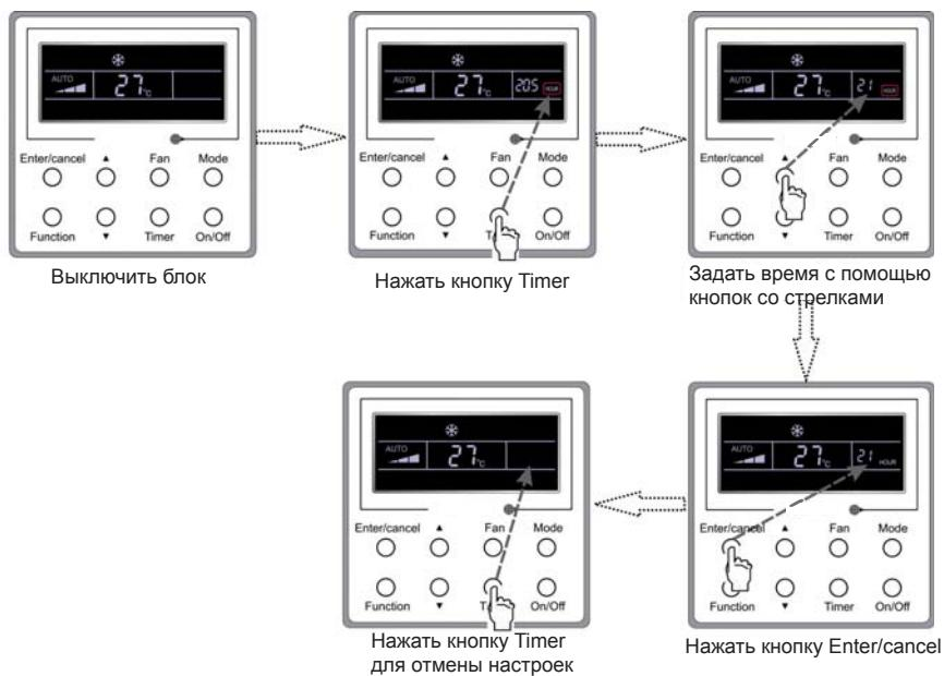
Рис. 8. Последовательность настройки таймера
